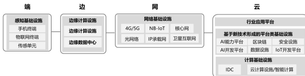
图 2-1 云网边端协同构建新一代信息基础设施
